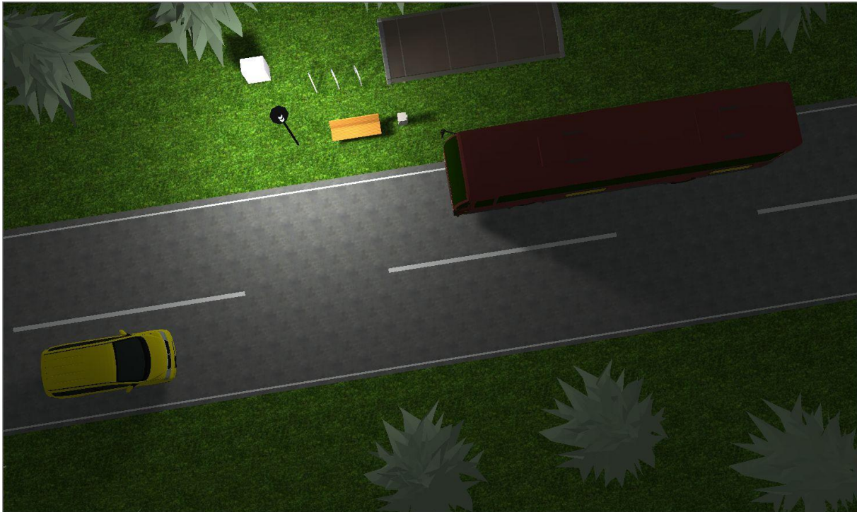
Abbildung 16: DIALux-Simulation einer mit AUBELE beleuchteten Bushaltestelle an einer Landstraße
