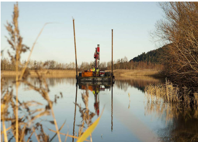
Entnahme von Probenmaterial aus einem der Bergeteiche am Bollrich. (Bildrechte: TU Clausthal)
