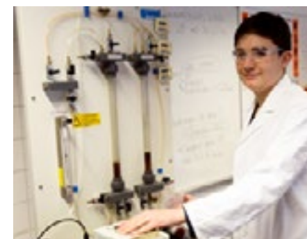
Bild: Großen Spaß bereitete Jonathan Tappe die Arbeit mit dem Ionen-Austauscher, bei dem Leitungswasser für die industrielle Anwendung demineralisiert wird.
